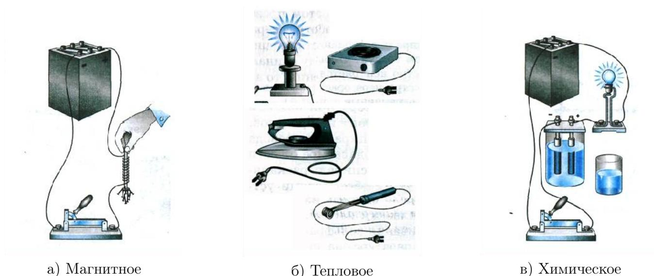
Рис. 30: Действия электрического тока.
