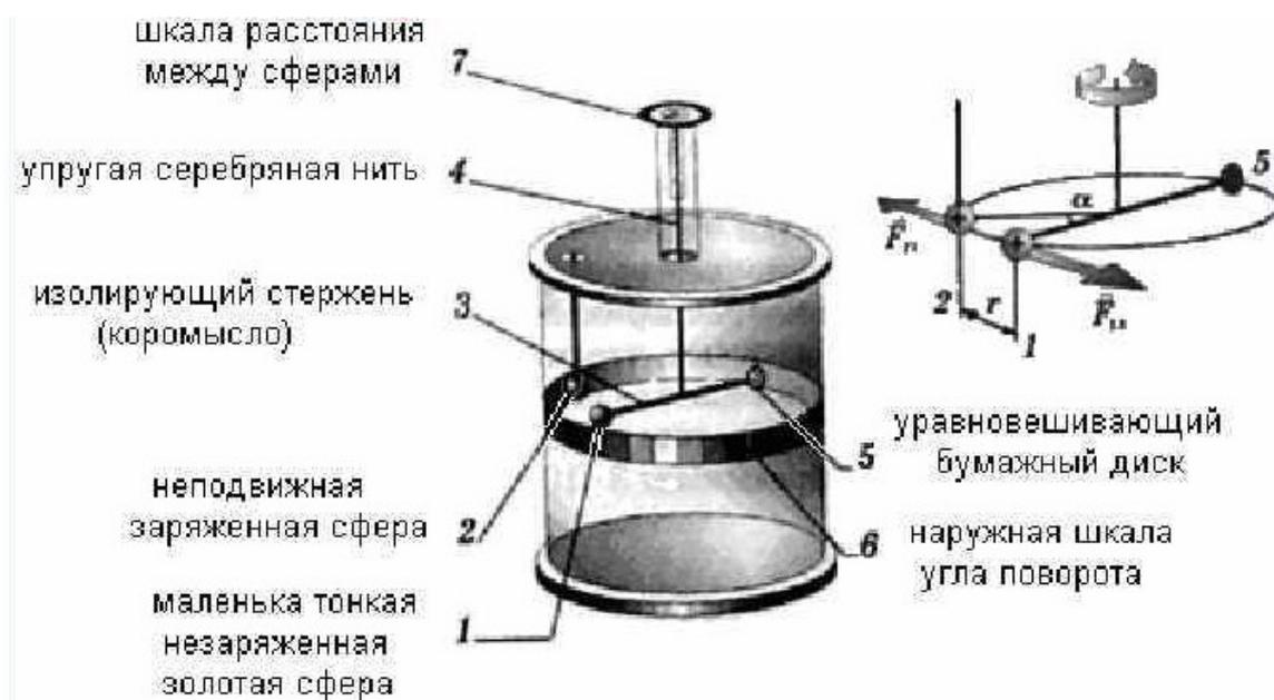
Рис. 29: Опыт Кулона по определению силы взаимодействия зарядов.
