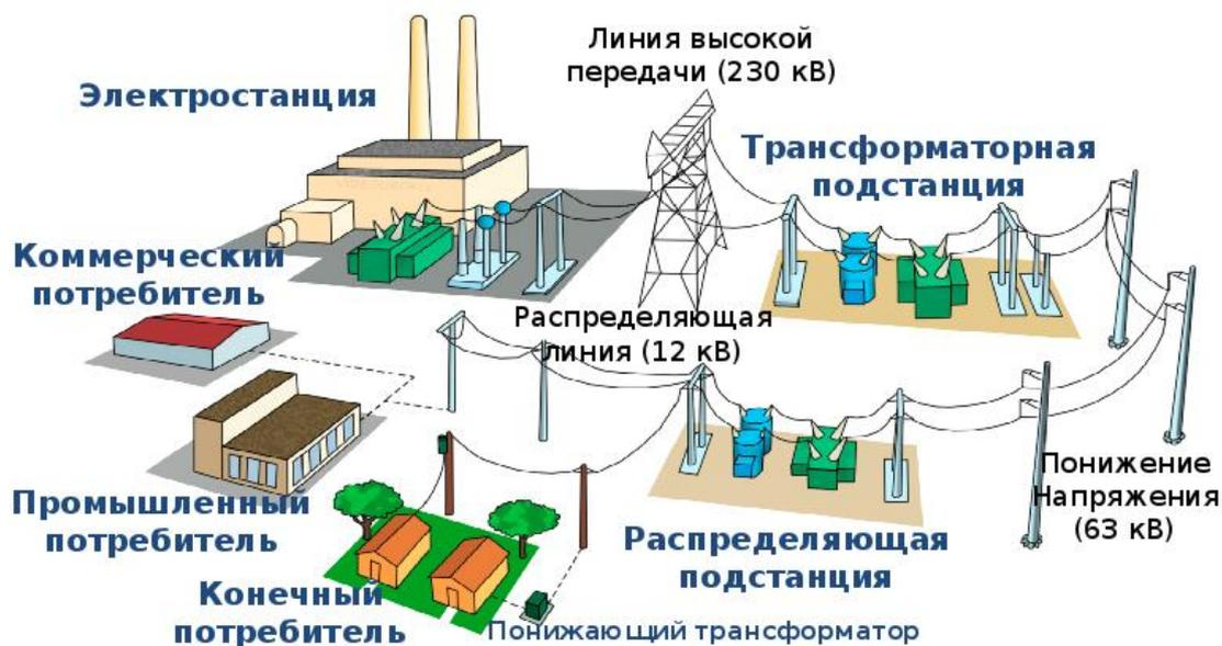
Рис. 55: Передача электроэнергии на расстояние.
