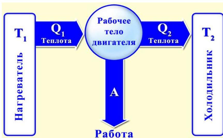
Рис. 125: Принцип действия тепловой машины.
