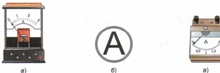
Рис. 35: Амперметр: а) Демонстрационный б) Обозначение на схеме в) Лабораторный
